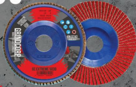
Die GC EXTREME 5030 ist konzipiert für hochfeste, hochlegierte Werkstoffe. Als Schleifmaterial wurde ein keramisches Korn auf einer festen Unterlage gewählt. Selbst gehärtete Materialien stellen kein Problem dar. Eine zusätzliche Wirkbeschichtung sorgt für Kühlung, um ein gleichbleibend gutes Ergebnis zu erzielen. Hohe Standfestigkeit durch große Lamellenanzahl. Das Schleifmittel ist völlig eisenfrei, daher ist EXTREME 5030 die beste Lösung für Schleifarbeiten auf Edelstahl (INOX).
